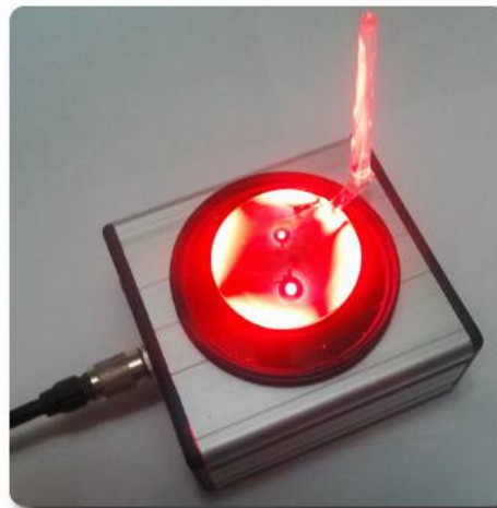
Anwendungsbeispiel: Sichtbarmachen von inneren Spannungen in klaren Spritzgießteilen mittels Polarisator und Analysator (hier an einer Linse mit Anguss)
